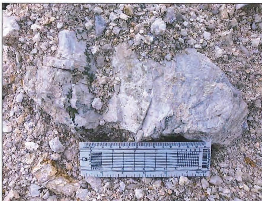
รูปที่ 2.11 ภาพถ่ายแสดงตัวอย่าง Float granite หินแกรนิตสด (Fresh Granite ) ตำแหน่งพิกัด 741849 E, 1457654 N ในบริเวณพื้นที่คำขอประทานบัตร
